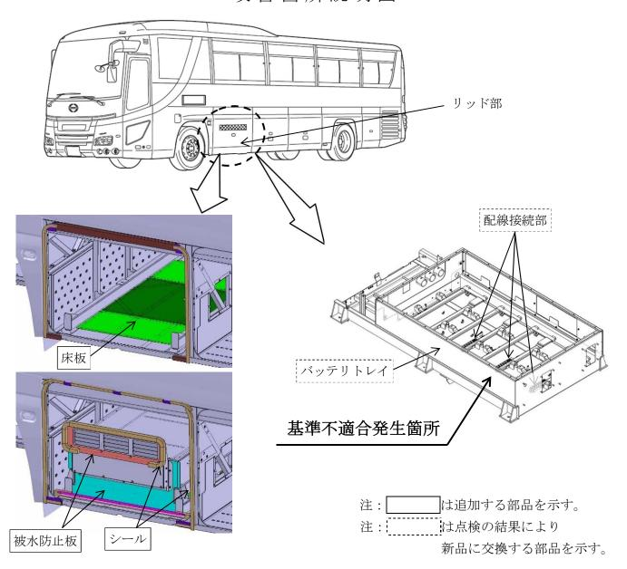
大型観光ハイブリッドバスのハイブリッド用バッテリトレイにおいて、トレイの防錆性が不足しているため、使用過程で腐食して穴があくことがある。そのため、トレイ内部に水が侵入し、バッテリの配線接続部に水が付着することで短絡して火災に至るおそれがある。
