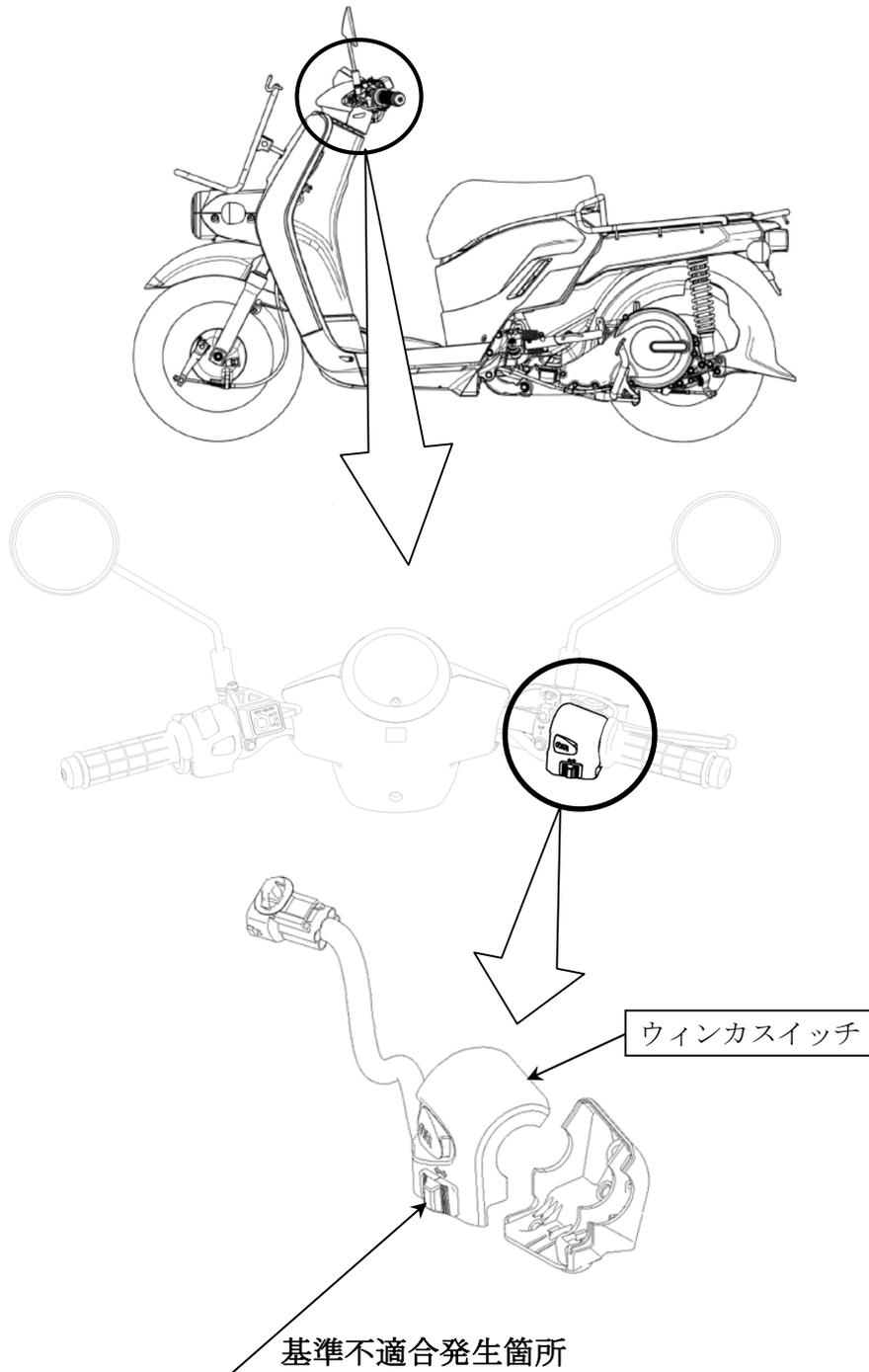
方向指示器において、ウィンカスイッチ構成部品の材料管理が不適切なため、正規と異なる材料で製造されたものがある。そのため、スイッチ内部に浸入した雨水等により構成部品が腐食し、最悪の場合、腐食が進行して部品が破損すると、方向指示器が作動しなくなるおそれがある。
