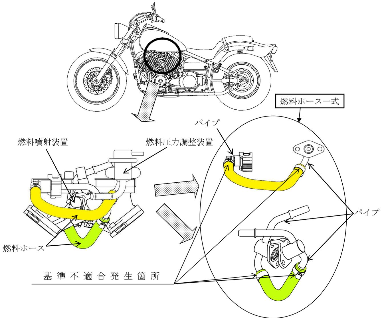
燃料ホースとパイプの接続部において、接着工程の熱処理により燃料ホースの弾性が損なわれ、当該接続部の気密性が不十分なものがある。そのため、当該接続部に高い燃料圧力が加わると、燃料が漏れるおそれがある。
