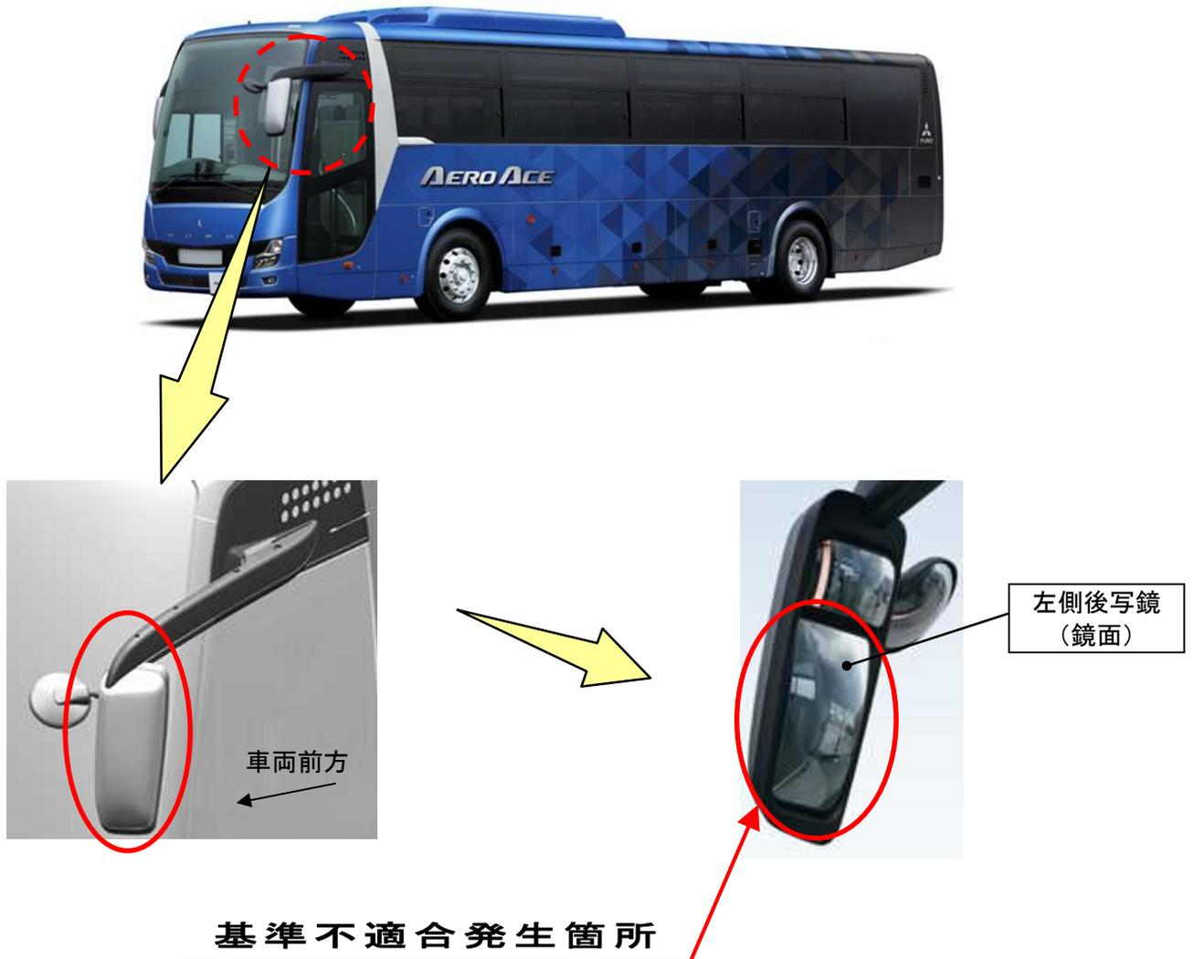
大型高速路線バスにおいて、曲率半径 620mm および 900mm の左側後写鏡を装着したものがある。そのため、路線バスとして使用した場合に、ワンマンバス構造要件に抵触するおそれがある。
