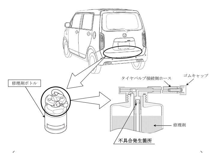
パンク応急修理用具において、修理剤ボトルの内部構成部品の組付け管理が不適切なため、シール性が不足しているものがある。そのため、タイヤバルブ接続側のホースからパンク修理剤が漏れ、最悪の場合、パンク応急修理ができなくなるおそれがある。
