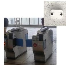
自動改札の上部にセンサーを設置し乗客数を検知
