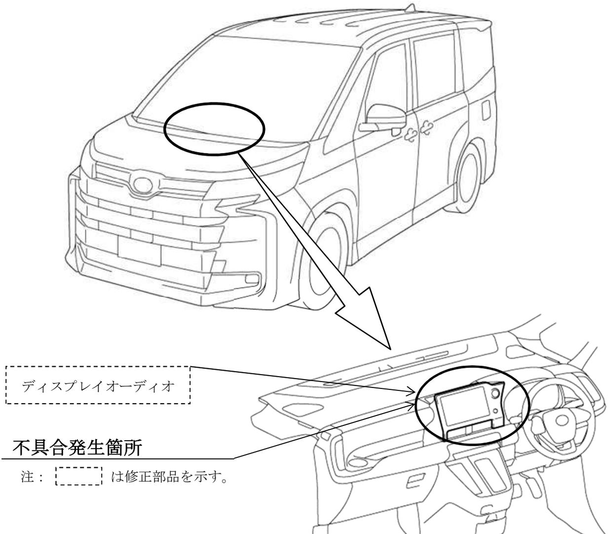
ディスプレイオーディオにおいて、制御プログラムが不適切なため、シフト操作もしくは車速入力時に画面表示の切替え指示が正しくされない場合がある。そのため、走行開始後も意図せず動画（テレビ映像等）が表示されたままとなるおそれがある。
