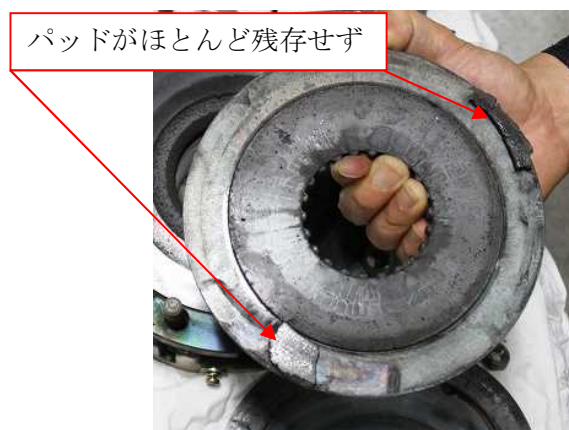
写真4. パッドの残存状態その2
