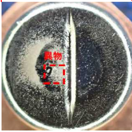
写真11. 1/L1極に付着していた異物
