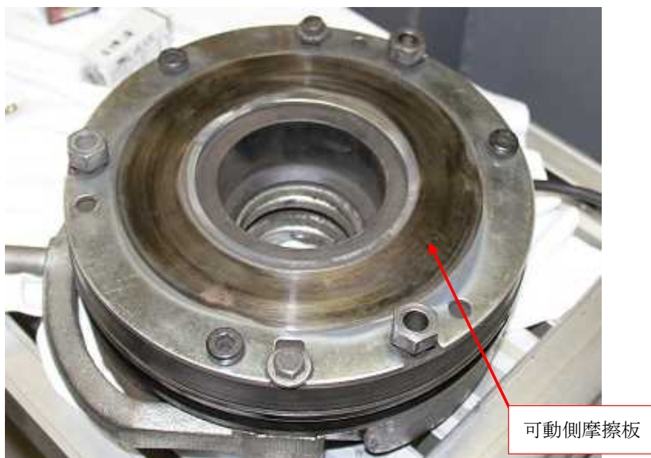
写真 3. 可動側摩擦板における擦過痕やへこみ
