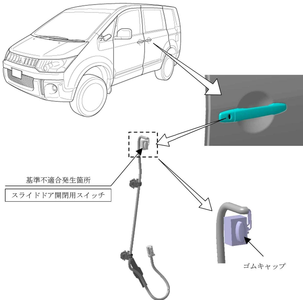
電動スライドドアの車外開閉用スイッチにおいて、製造不良によりゴムキャップに亀裂が入っているものがあり、亀裂部からスイッチ内部に浸入した水分により通電することがある。そのため、停車時や極低速走行時等の特定条件下で、意図せずスライドドアが開閉するおそれがある。
