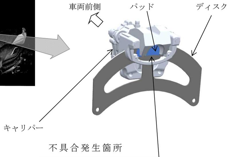
スタンディングアシストにおいて、改善対策届出番号640による措置を実施しても、措置前と同様に、スタンディングアシストの解除操作をしてもキャリパーのパッドがディスクから離れず、自立の補助が維持される場合がある。そのため、最悪の場合、カーブ等で車両を傾けられず転倒するおそれがある。
