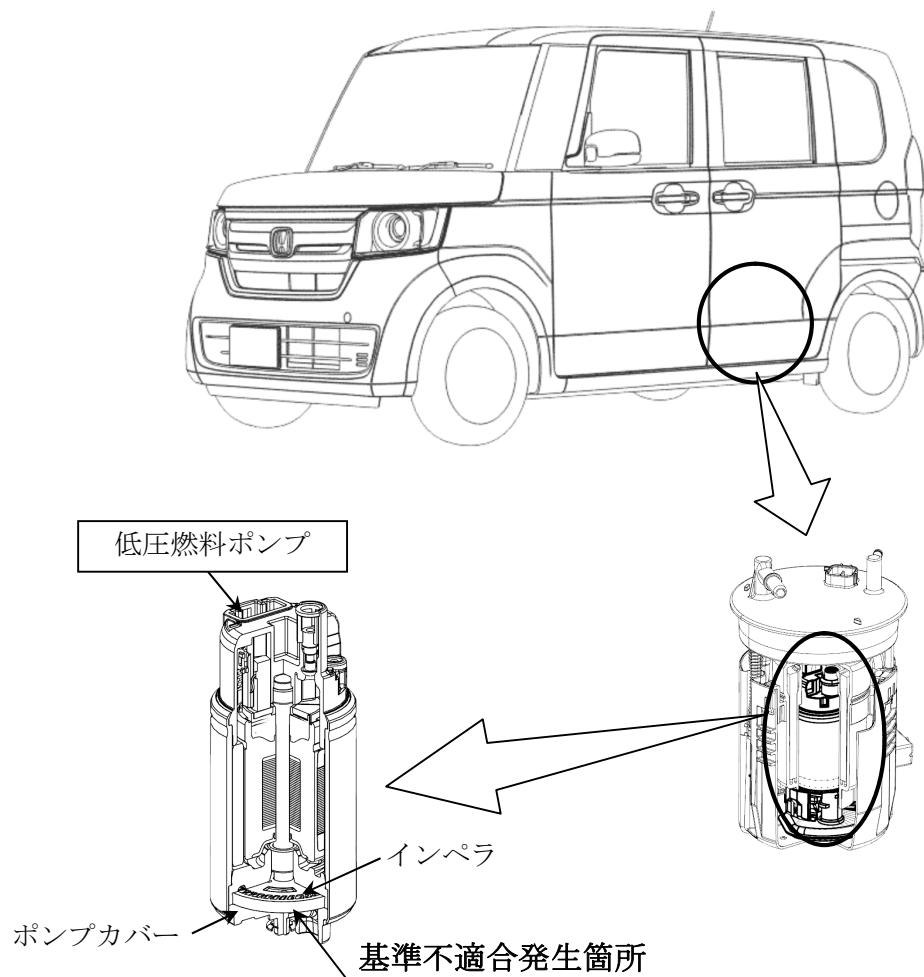
低圧燃料ポンプのインペラ（樹脂製羽根車）において、成形条件が不適切なため、樹脂密度が低くなってしまい、燃料により膨潤して変形することがある。そのため、インペラがポンプカバーと接触して燃料ポンプが作動不良となり、最悪の場合、走行中エンストに至るおそれがある。
