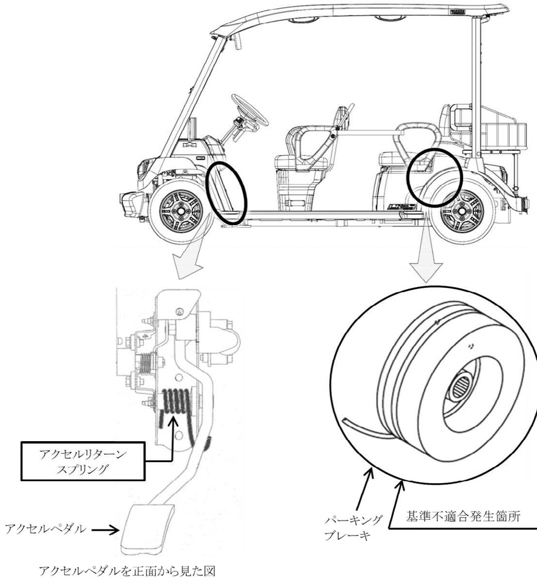
アクセルペダルを戻すためのアクセルリターンスプリングの強度が不足している。そのため、そのまま使用を続けると、当該スプリングが折損し、最悪の場合、アクセルペダルが戻りきらない他、手動運転時に、パーキングブレーキが作動しなくなるおそれがある。
