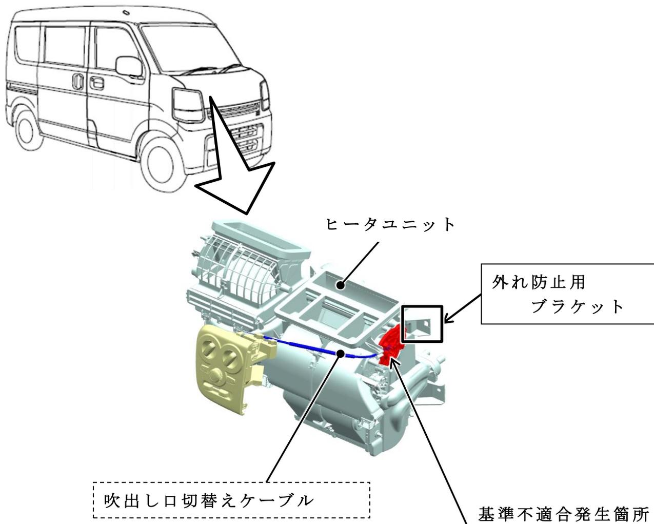
マニュアルエアコンのヒータユニットにおいて、吹出し口切替え機構の構造が不適切なため、高温条件下で吹出し口切替えダイヤルを素早く操作すると、内部部品が外れ、操作不能になる場合がある。そのため、デフロスタが使用できず、前面ガラスの視野を確保できなくなるおそれがある。
