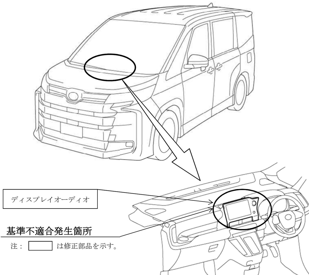
ディスプレイオーディオにおいて、制御プログラムが不適切なため、ナビのルート案内中に車両を再始動し、直後にパノラミックビューモニターの映像を表示した場合、ナビ案内図を車両左側の映像に重ねて表示する場合があります。そのため、車両左側の映像が確認できず、保安基準第44条（後写鏡等の基準）に適合しないおそれがある。
