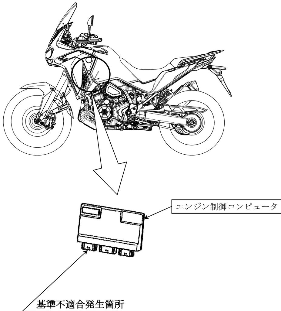
エンジン制御コンピュータ（ECU）において、車載式故障診断装置の制御プログラムが不適切なため、故障診断データの処理が重なると、当該データが破損することがある。そのため、異常を検知しECUがリセットして、エンストするおそれがある。なお、6速DC T型自動変速機搭載車両においては、フェールセーフが働きクラッチが切れ、駆動力が伝わらなくなり、走行不能となるおそれがある。
