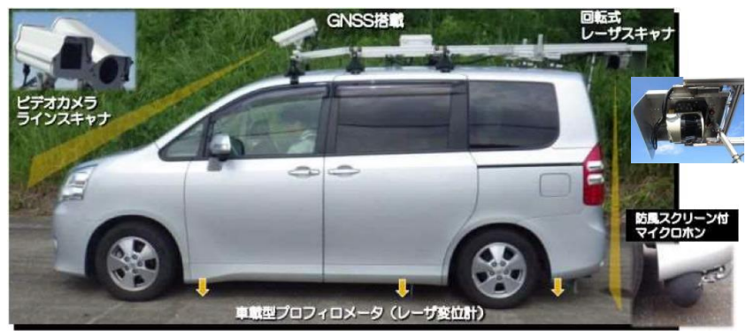
車載型の計測装置による路面性状の測定
