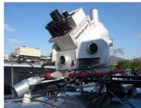
車載装置による路面性状測定
