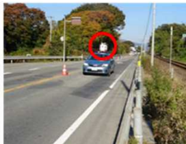
車載装置による路面性状測定
