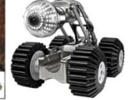
テレビカメラによる 管路の点検・調査
