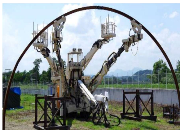
鋼製支保工建込みロボット 前田建設工業/古河ロックドリル/マック
