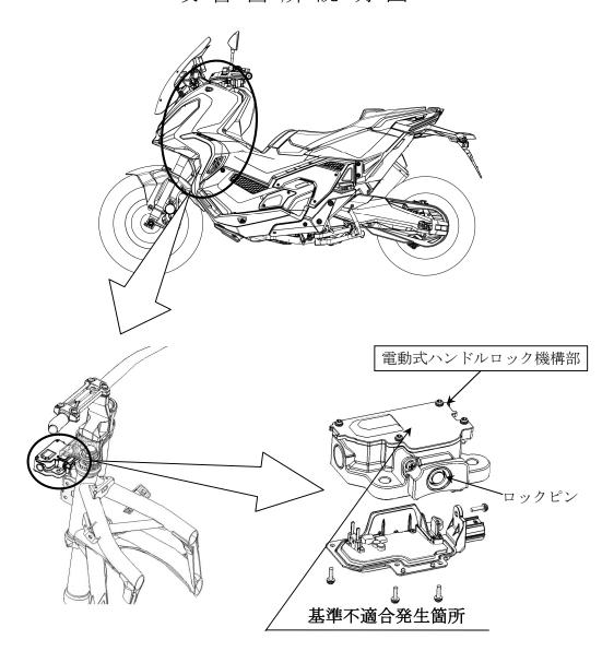
施錠装置の電動式ハンドルロックにおいて、ハンドルロック機構部のロックピン位置設定が不適切かつ構成部品の強度が不足しているため、ハンドルロック時にロックピンがロックホールに入らないと、構成部品のギヤに衝撃が加わり破損することがある。そのため、ロックピンが動かなくなり、最悪の場合、ハンドルロックの施錠又は解錠ができなくなるおそれがある。
