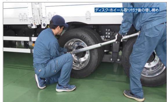
タイヤ脱着後、50km~100km 走行後を目安に、ホイール・ナットを既定のトルクで再度締め付けます
