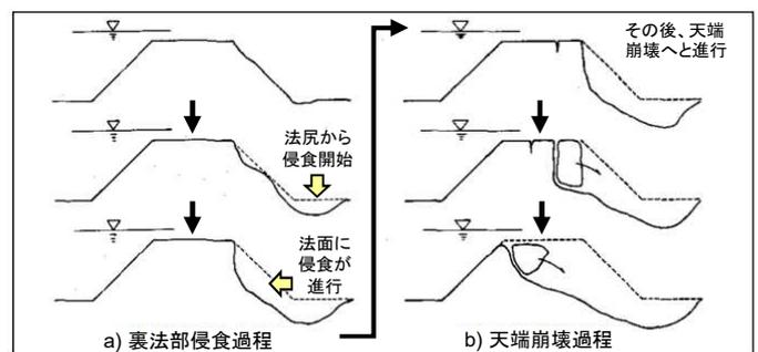
図-4 越水による河川堤防の壊れ方
