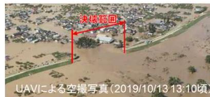
図-2 越水による決壊(千曲川)
