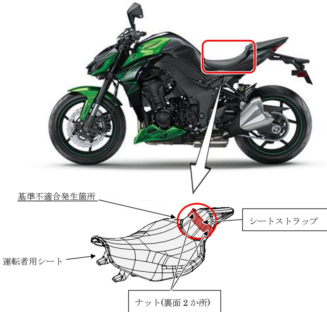
乗車装置の運転席(運転者用シート)に取り付けられた後部座席握り手(シートストラップ)において、製造時の加工条件が不適切なため、強度が不足しているものがある。そのため、そのままの状態で使用を続けると、走行中にシートストラップが破損し、同乗者の安全な乗車を確保できないおそれがある。
