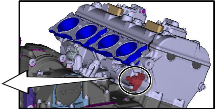
カムシャフトチェーンの張力を調整するテンショナにおいて、使用により内部の部品が劣化しプランジャが押し戻され、プランジャがロックすることがある。プランジャがロックされた状態で使用を続けると、カムシャフトチェーンに張力が掛からずに異音が発生し、最悪の場合、カムシャフトタイミングがずれ、走行中にエンジンが停止することがある。
