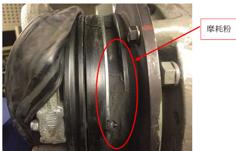
写真4. ダストカバーリングを外した状態のブレーキにおける摩耗粉
