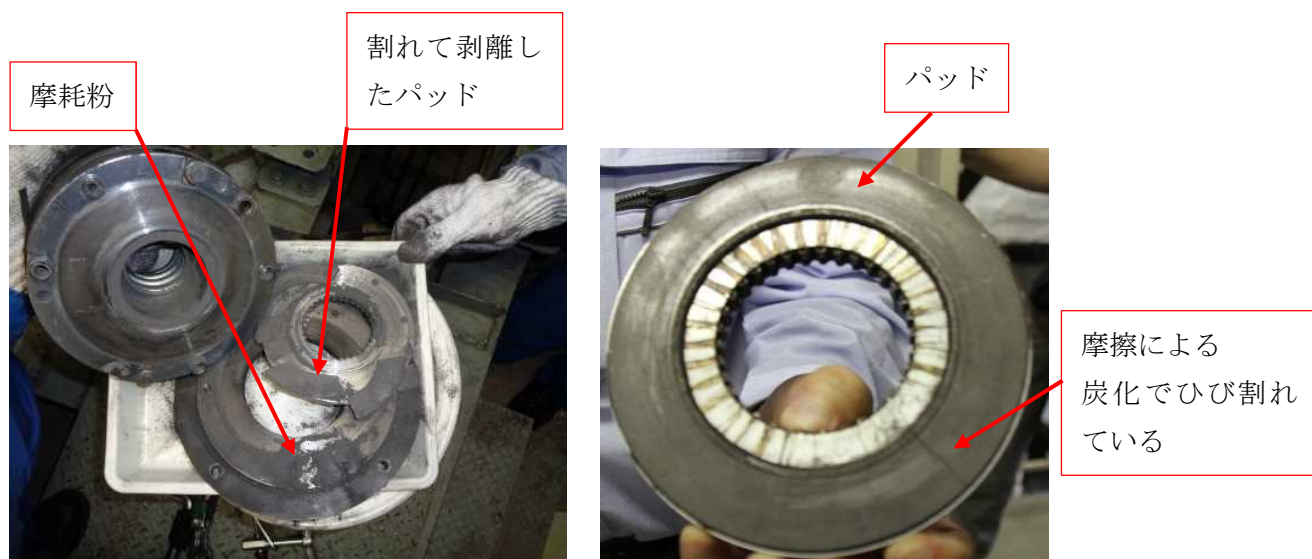
写真5. パッドの状況 (左：アーマチュア側、右：固定側摩擦板側)
