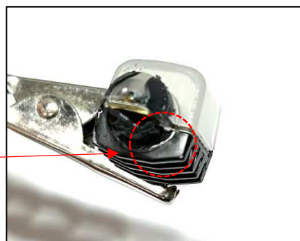
絶縁塗膜の剥離 (両極が剥離した場合に導電)
