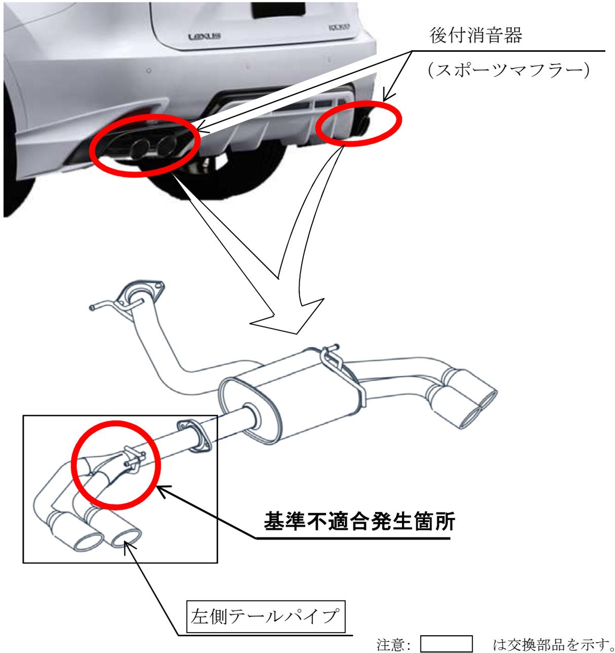
レクサスRX450h(ハイブリッド仕様車)用の後付消音器において、左側テールパイプの強度が不足していたため、亀裂が発生し異音が出て、排気が漏れる場合がある。
