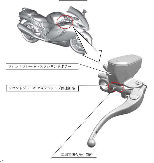
フロントブレーキマスタシリンダボデーにおいて、ブレーキの液圧を調整するための油路の設定が不適切なため、その油路を閉塞したままとなることがある。そのため、特定の条件下でブレーキレバーの遊びが大きくなり、最悪の場合、制動距離が伸びるおそれがある。
