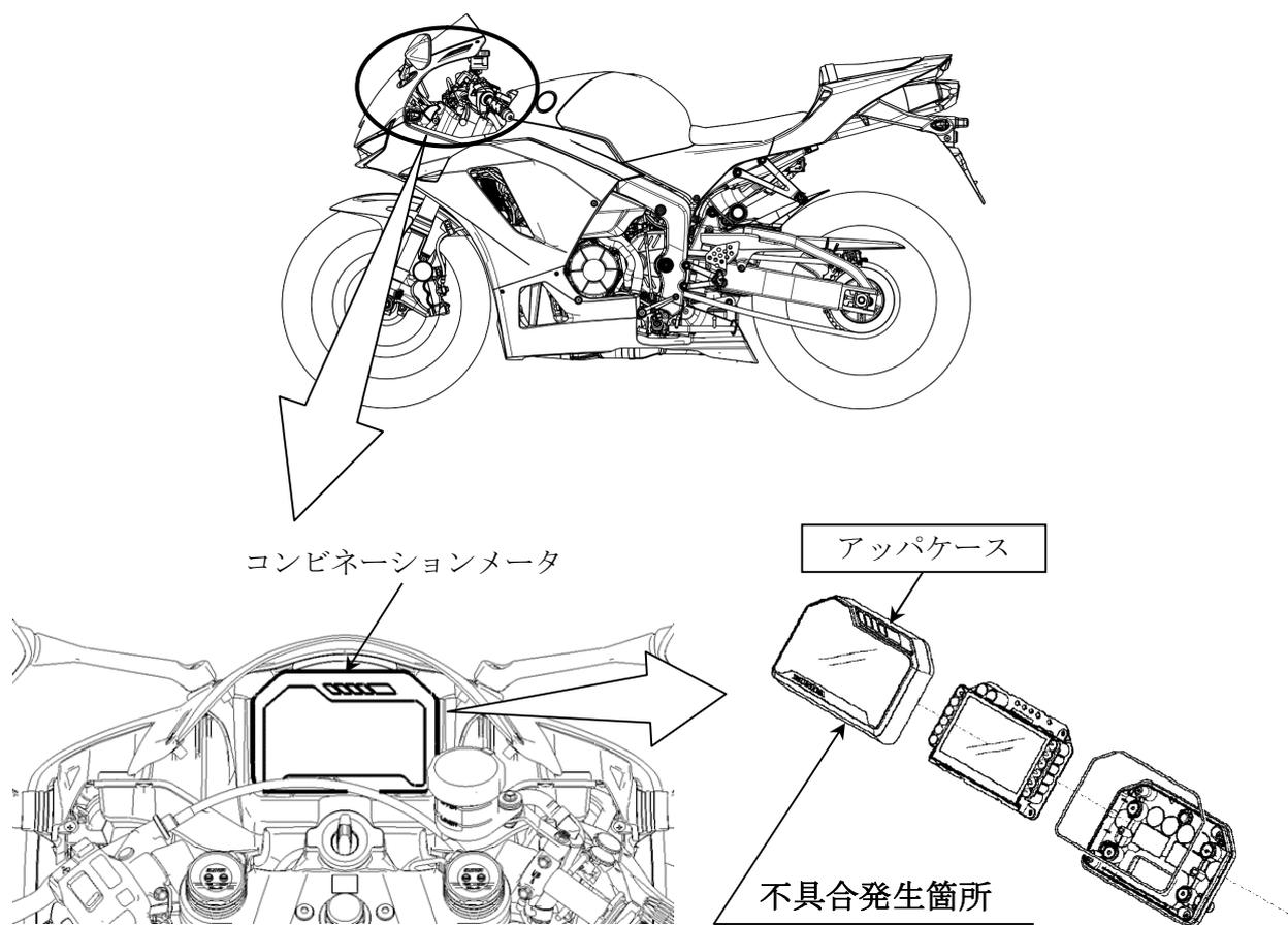
補修用部品として販売したコンビネーションメータのアップケースにおいて、適用指示が不適切なため、ABS警告灯及びHISS（盗難防止装置）表示灯が点灯した際に視認できない。
