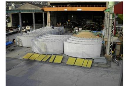
リング状のプレキャストコンクリートの製造
