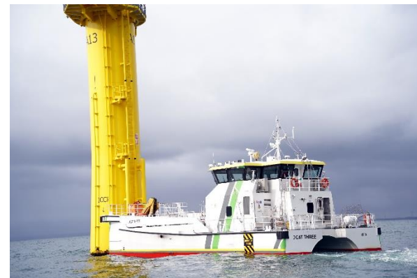
洋上風力発電施設への接舷の様子 (出典：東京汽船(株)HP)
