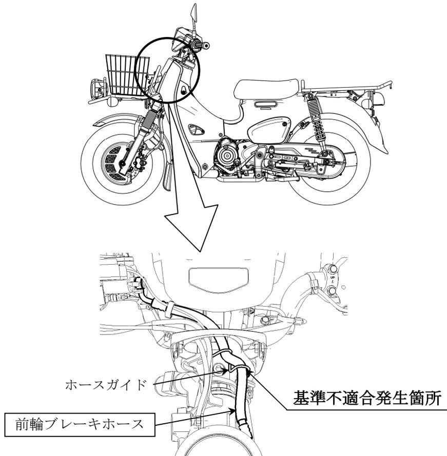
制動装置において、前輪ブレーキホースの車体への組付け作業が不適切なため、正しい位置に組付けられていないものがある。そのため、当該ホースがホースガイド端部と接触し、そのまま使用を続けると、当該ホースが損傷し、最悪の場合、ブレーキ液が漏れ、前輪ブレーキが効かなくなるおそれがある。
