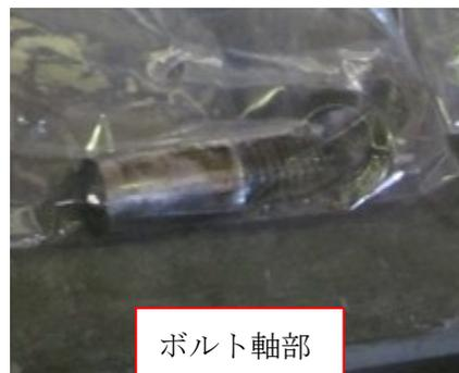
写真6 破断したリーマボルト (6本中の1本)
