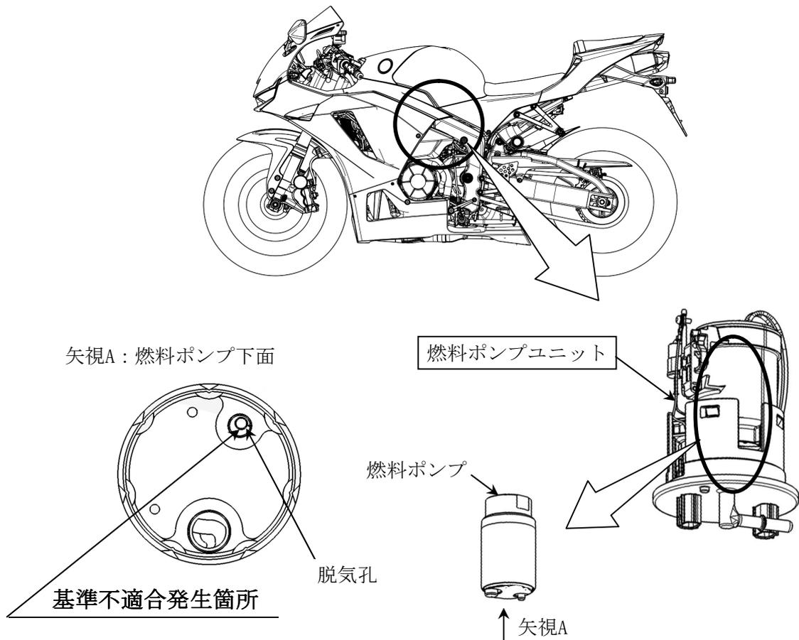
燃料ポンプにおいて、燃料蒸発ガスを排出するための脱気孔位置が不適切なため、高地等での気圧が低い環境下での走行、または外気温が高い環境下での渋滞路走行等により、燃料蒸発ガスが排出されず、燃料ポンプ内に多量に滞留することがある。そのため、燃料供給ができなくなり、エンストに至るおそれがある。
