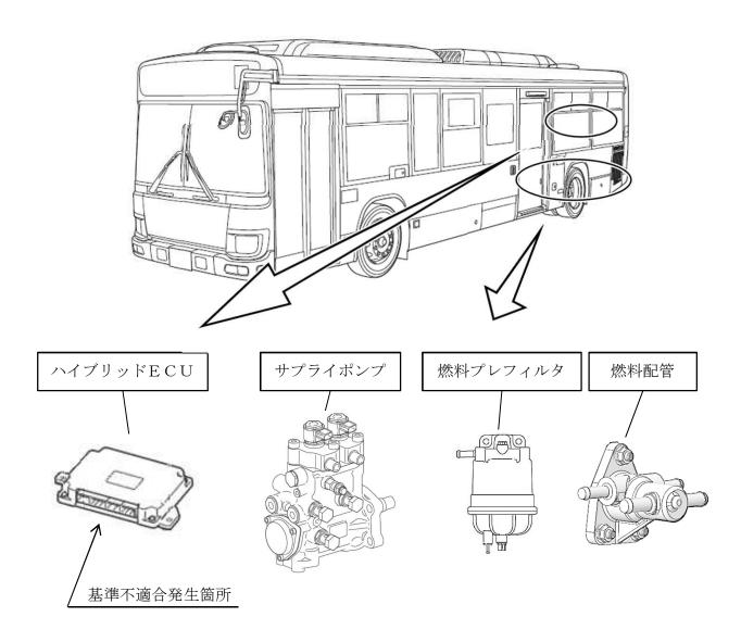
大型ハイブリッド路線バスにおいて、ハイブリッド制御プログラムが不適切なため、エンジン始動時にサプライポンプの摺動部が、燃料中の異物等により潤滑不良となり摩耗することがある。そのため、そのまま使用を続けるとポンプが破損し、走行できなくなるおそれがある。
