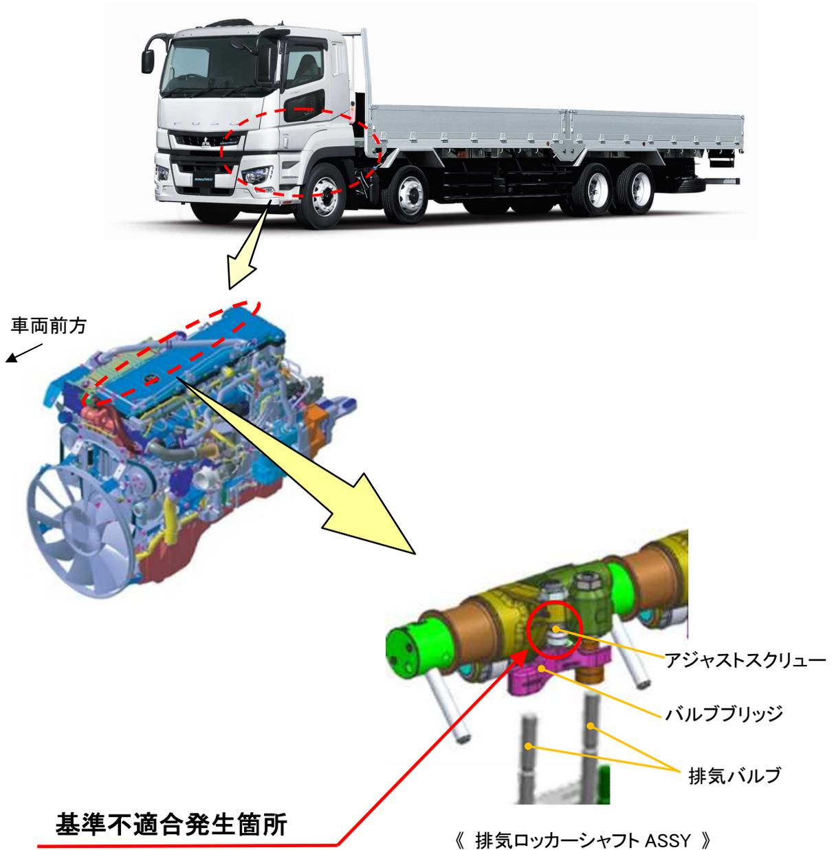
6R20 型エンジンを搭載した大型トラックにおいて、排気ロッカーアームのアジャストスクリューの潤滑性能が不十分なため、長時間のアイドル運転を行うと早期にアジャストスクリューが摩耗及び破損して異音や出力の低下が生じることがある。そのため、そのままの状態で使用を続けると、バルブブリッジが脱落してエンジンが破損し、最悪の場合、走行不能に至るおそれがある。
