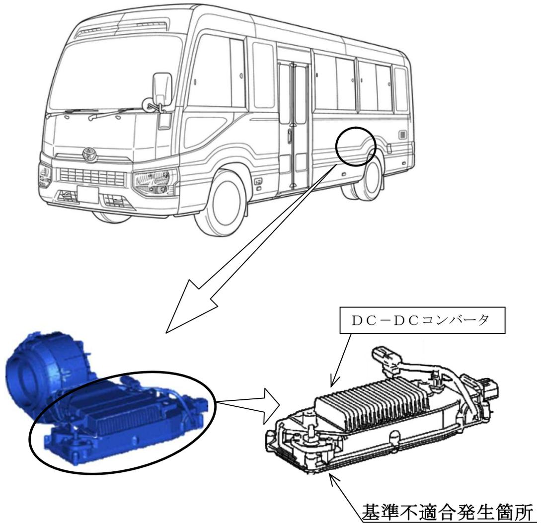
電圧変換装置（DC-DCコンバータ）の電流整流モジュールにおいて、内部の部品構造が不適切なため、製造ばらつき等により使用過程で当該モジュールが故障した際、短絡回路が形成されることがある。そのため、警告灯が点灯するとともに補機バッテリーから電流が流れ続けて発熱し、最悪の場合、火災に至るおそれがある。
