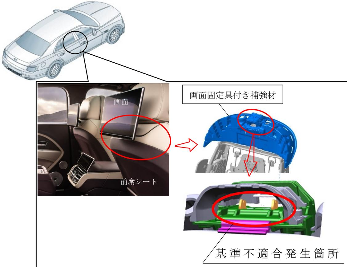
後席乗員用マルチメディアシステムの脱着式画面を装着する固定具において、組立指示が不適切なため、固定具が間違って組立てられている、または一部の部品が取付けられていないものがある。そのため、当該画面を装着した時に固定が不十分となり、車両衝突時に画面が外れ、乗員が負傷するおそれがある。
