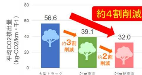
ダブル連結トラックによるCO<sub>2</sub>削減効果
