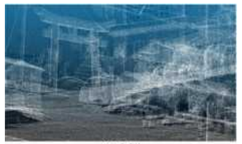
現地で計測した3D点群データ
