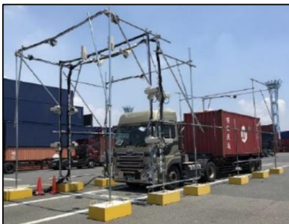
ダメージチェックシステムのプロトタイプモデルでの試験の様子
