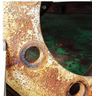
（ディスク・ホールのボルト穴や、ホイール・ナットの当たり面に、著しいさびによる剥離や損傷が発生している。）
