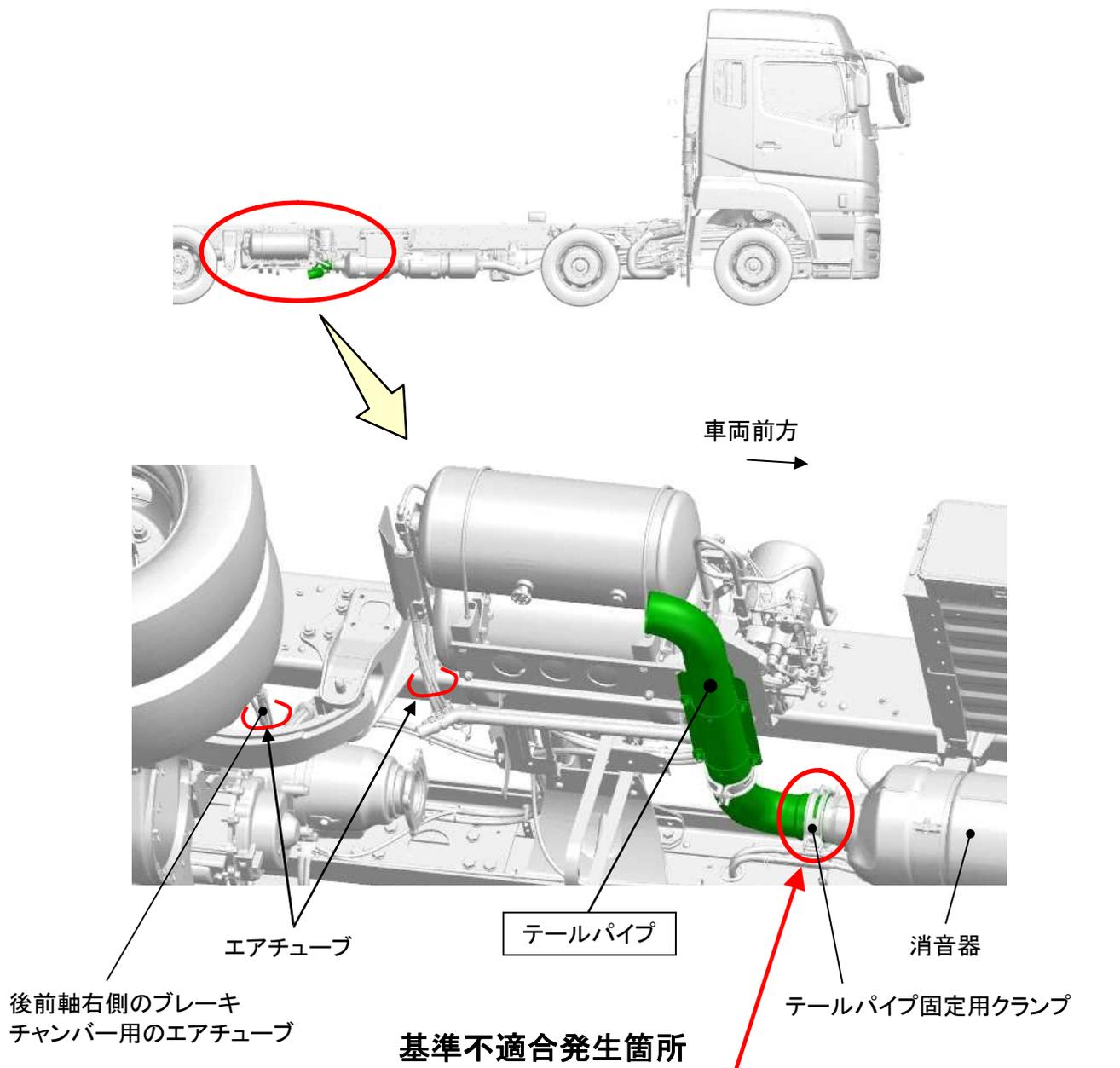
大型トラックにおいて、消音器に結合されるテールパイプの材質が不適切なため、結合部に融雪剤等が残った状態で使用を続けると、結合部のテールパイプが腐食して破断し、消音器出口からの排気ガスによってエアチューブが溶損することがあり、最悪の場合、ブレーキ制動力の低下/失陥、突然の駐車ブレーキ作動、T/M の変速不良が生じるおそれがある。また、破断したテールパイプの固定用クランプが破損すると、テールパイプが落下して他の交通の安全に影響を及ぼすおそれがある。
