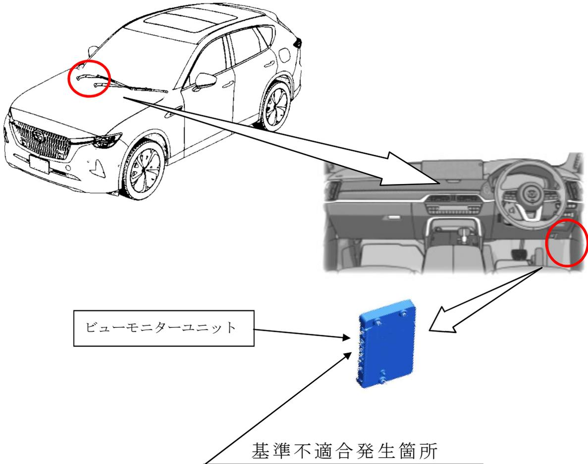
ビューモニターユニットにおいて、システムの起動条件が不適切なため、起動時にサイド及びバックカメラに切り替えるシステムが起動しないことがある。そのため、i-ACTIVENSE 警告灯が点灯し、ビューモニターユニット異常を知らせるメッセージがメータ内ディスプレイに表示される。また、サイド及びバックカメラの映像が表示できないおそれがある。
