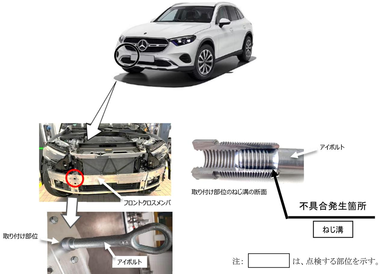
フロントクロスメンバにある牽引用アイボルトの取り付け部位において、ねじ溝の加工が不適切なため、必要な深さまでアイボルトが装着できないものがある。そのため、牽引時に使用すると負荷に耐えられず、アイボルトが外れることで、最悪の場合、事故や怪我に至るおそれがある。
