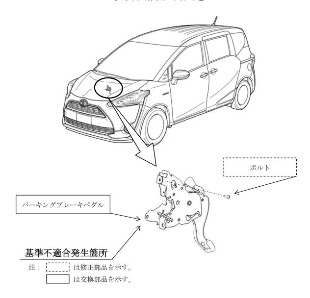
足踏み式パーキングブレーキにおいて、ペダルをボデーに固定するボルトの締付トルク指示が不適切なため、締結力が不足しているものがある。そのため、使用過程で当該ボルトが緩んで脱落し、最悪の場合、パーキングブレーキの操作ができなくなるおそれがある。
