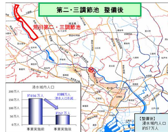
<流量規模1/100による浸水範囲の比較(荒川下流域における破堤シミュレーション結果)>
