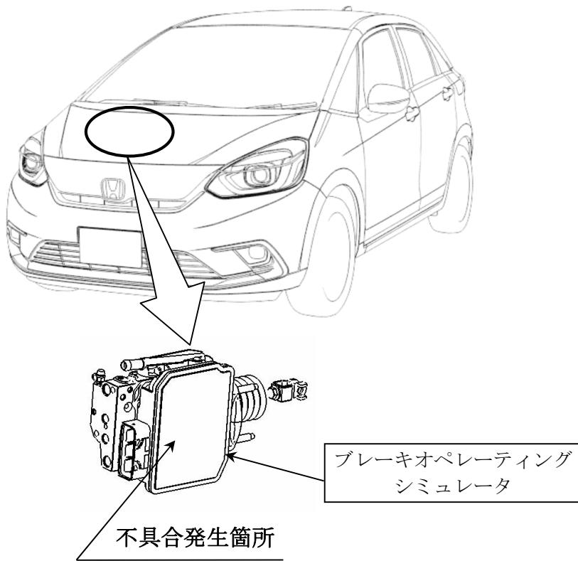
電動サーボブレーキシステムのブレーキオペレーティングシミュレータにおいて、製造工程が不適切なため、製造時に使用する組付け油が圧力センサ内に浸入することがある。そのため、使用過程で当該センサ内の抵抗部が腐食し、出力値が異常となり、警告灯が点灯するとともにフェールセーフが働き、ブレーキペダルの操作力が増大するおそれがある。
