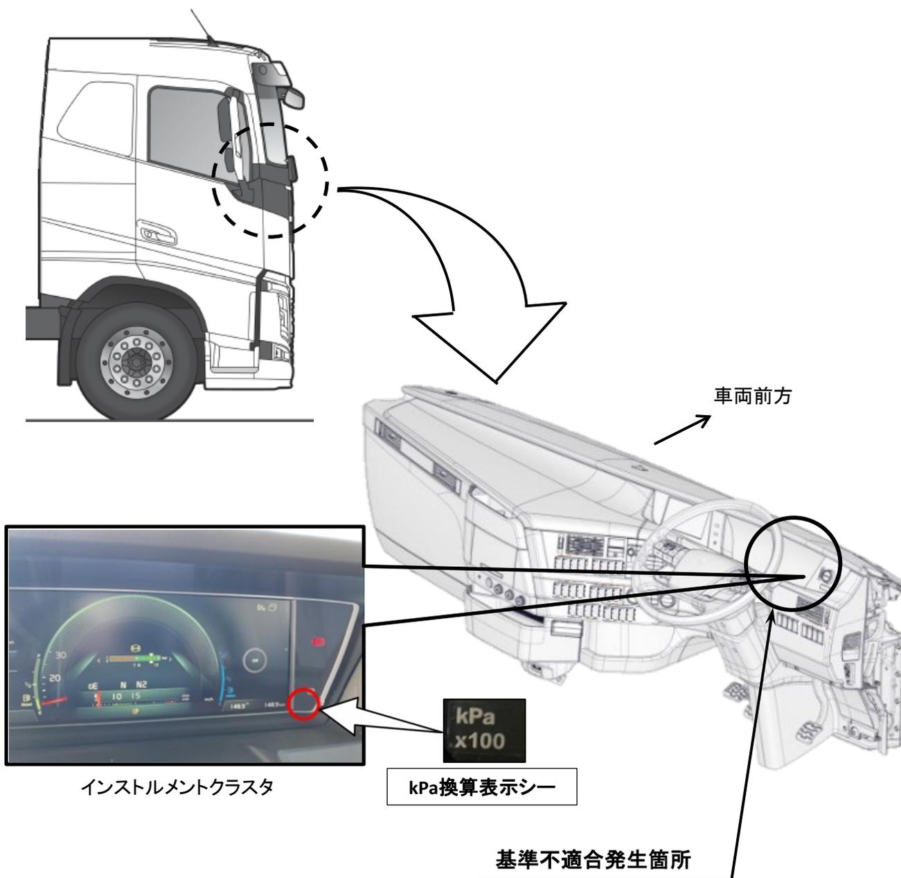
液晶ディスプレイに表示される空気圧力計の単位表示において、国内における作業指示が不適切なため、SI単位に換算する表示の貼付がされていない。そのため、道路運送車両の保安基準第47条の2にかかる内圧容器圧力表示の規定に適合しない。
