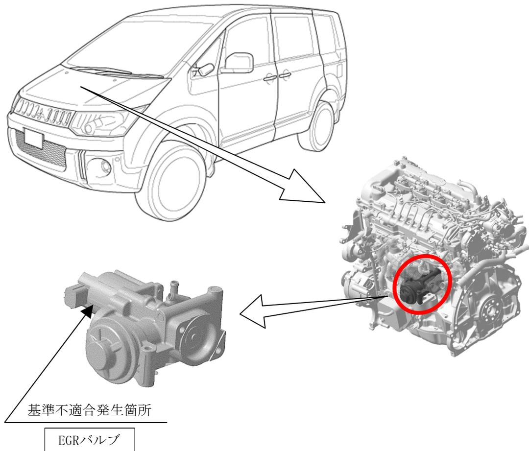
EGR(排気ガス再循環装置)バルブの内部モーターにおいて、渋滞路走行等における作動頻度が想定を超えており、内部モーターの配電ブラシが早期に摩耗し、導通不良となり、EGRバルブが作動しなくなることがある。そのため、エンジン警告灯が点灯し、排出ガスが規制値を満足しなくなるおそれがある。
